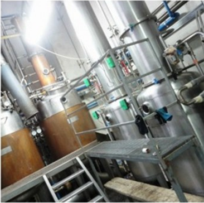
impianto discontinuo di distillazione e adduzione di vinacce all'impianto
